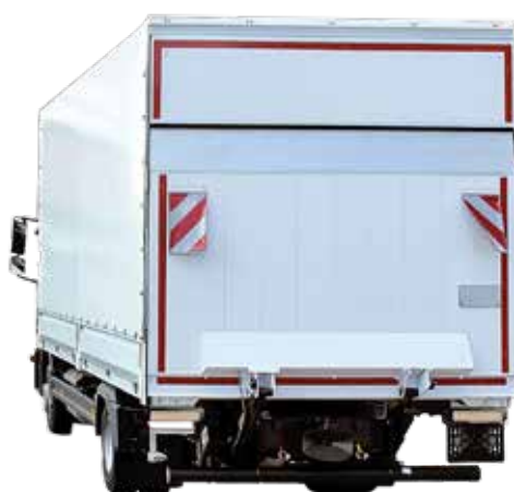
Som baglygte med baklygtefunktion Installationshøjde max. 1.200 mm
